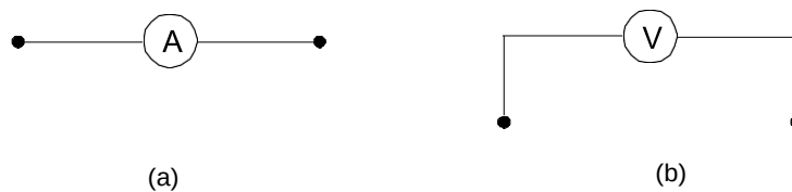
Fig. 1: Símbolos utilizados en teoría de circuitos para designar un amperímetro (a) y un voltímetro (b).
