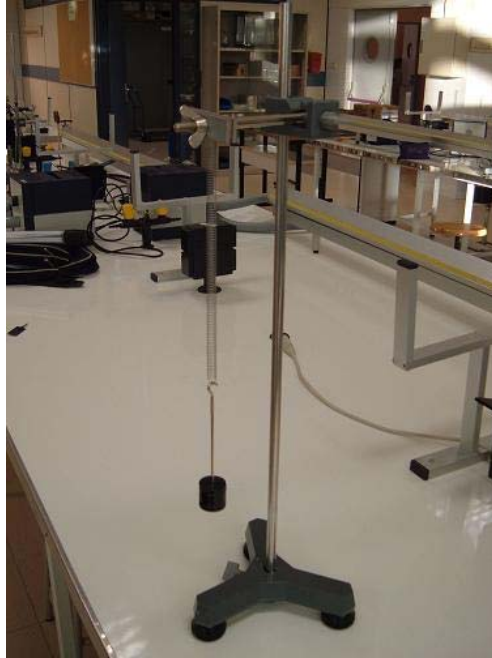
Fig. 1. Montaje experimental para estudiar las oscilaciones del muelle
