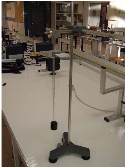
Fig. 1. Muntatge experimental per a estudiar les oscil·lacions del moll
