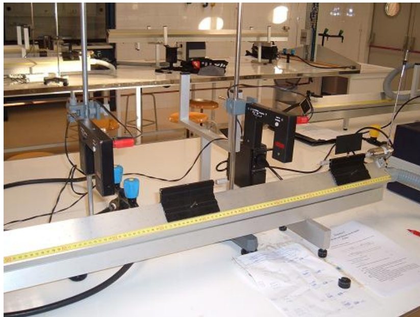
Fig. 1. Montaje experimental para el estudio de las colisiones.
