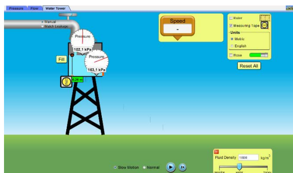
Fig. 3. Mesura i comprovació de la diferència de pressions.
