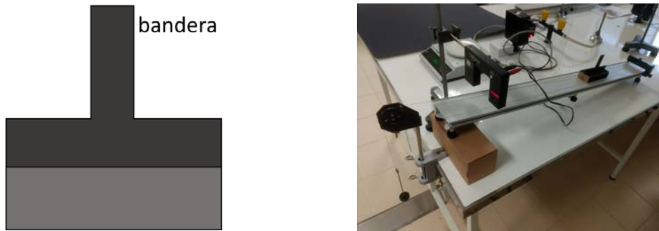
Fig. 3. Muntatge experimental: (esquerra) patí i (dreta) muntatge amb la cèl·lula fotoelèctrica.
