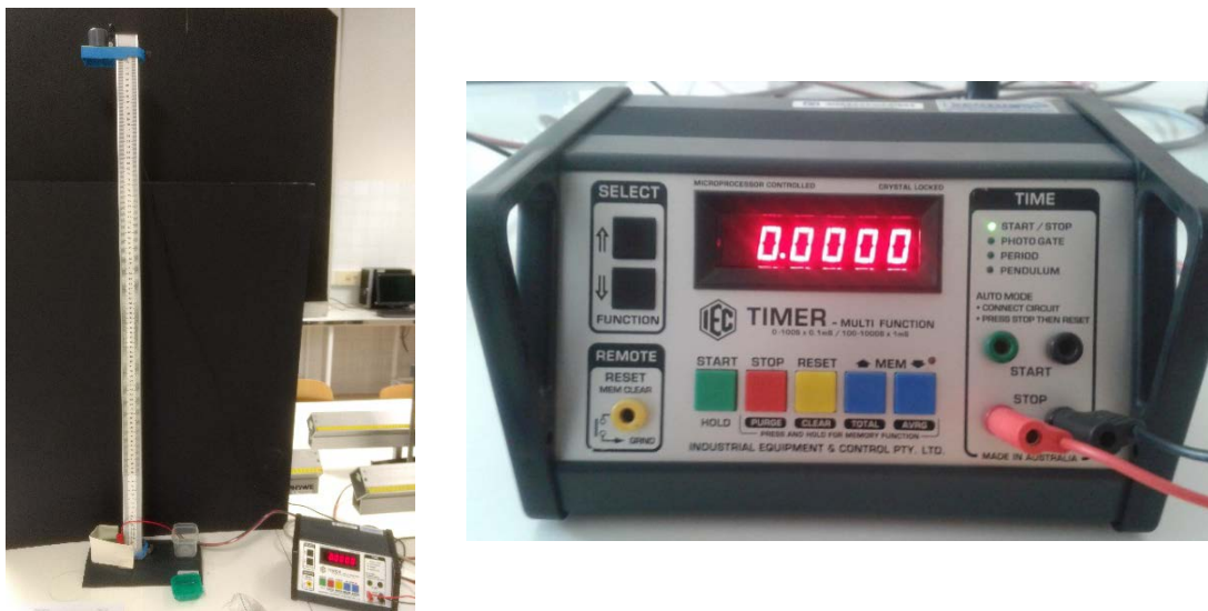
Fig. 1. Vista de la torre con el dispositivo magnético de lanzamiento, izquierda, y del módulo de control, derecha (a diferente escala).
