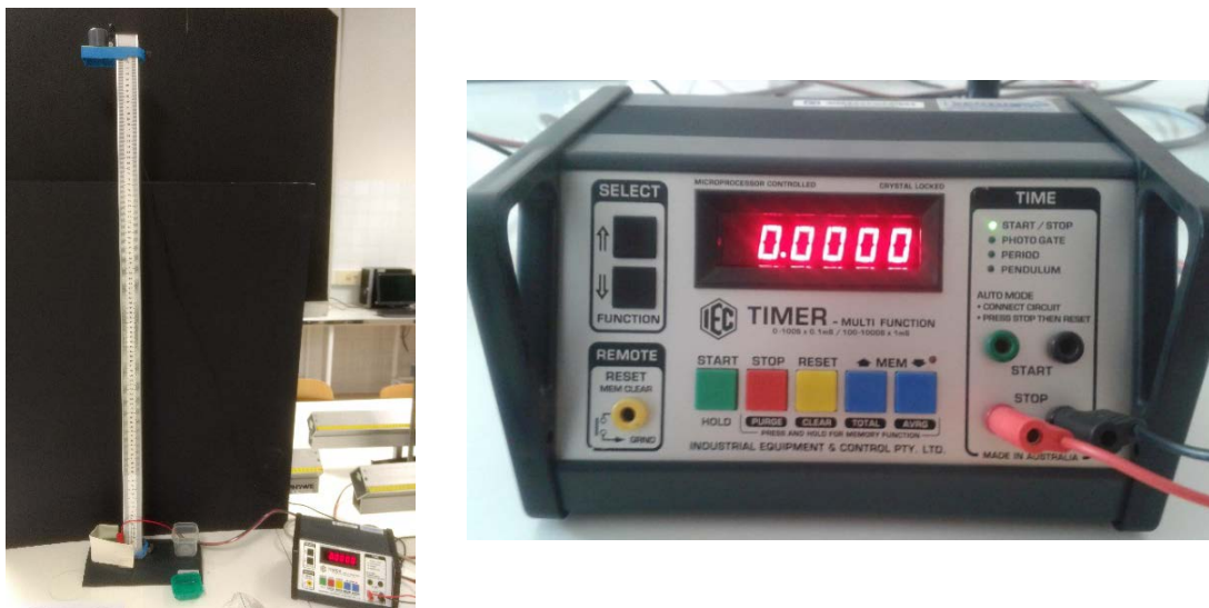
Fig. 1. Vista de la torre amb el dispositiu magnètic de llançament, esquerra, i del mòdul de control, dreta (a diferent escala).
