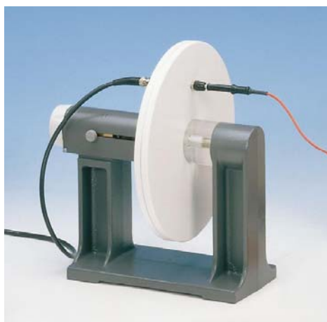
Figura 7.- Condensador de placas plano-paralelas.
